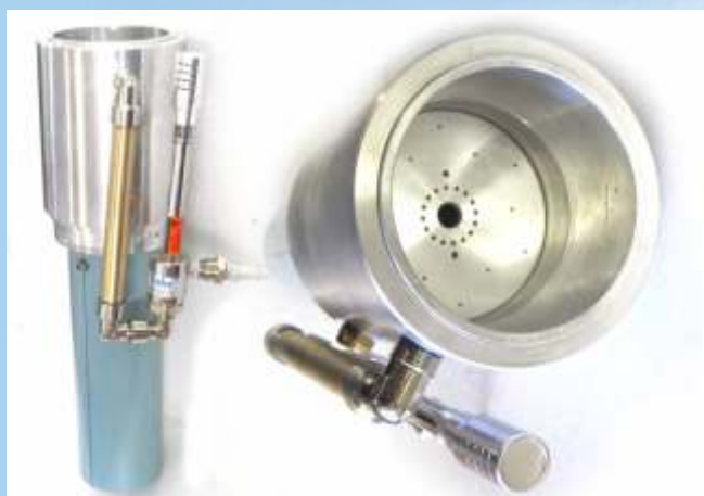
NUOVO SISTEMA EXTRA-COOLING con scambiatore di calore per una spruzzatura a fiamma prolungata
